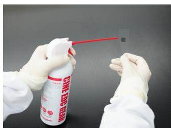
d. 如芯片表面无杂质、无明显痕迹，无任何液体残留、无波纹状纹理，即可准备贴片；
